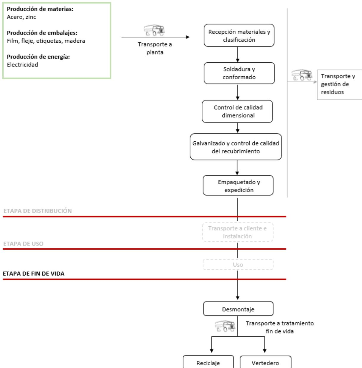
Imagen 1 Diagrama de proceso de producción.
